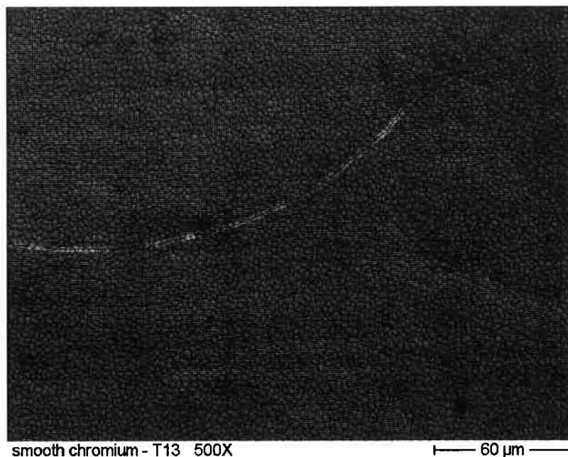
Figura 24: Aspecto da superfície da camada de cromo obtida no ensaio t 13; MEV, imagem de elétrons secundários. Aumento: 500 X.
